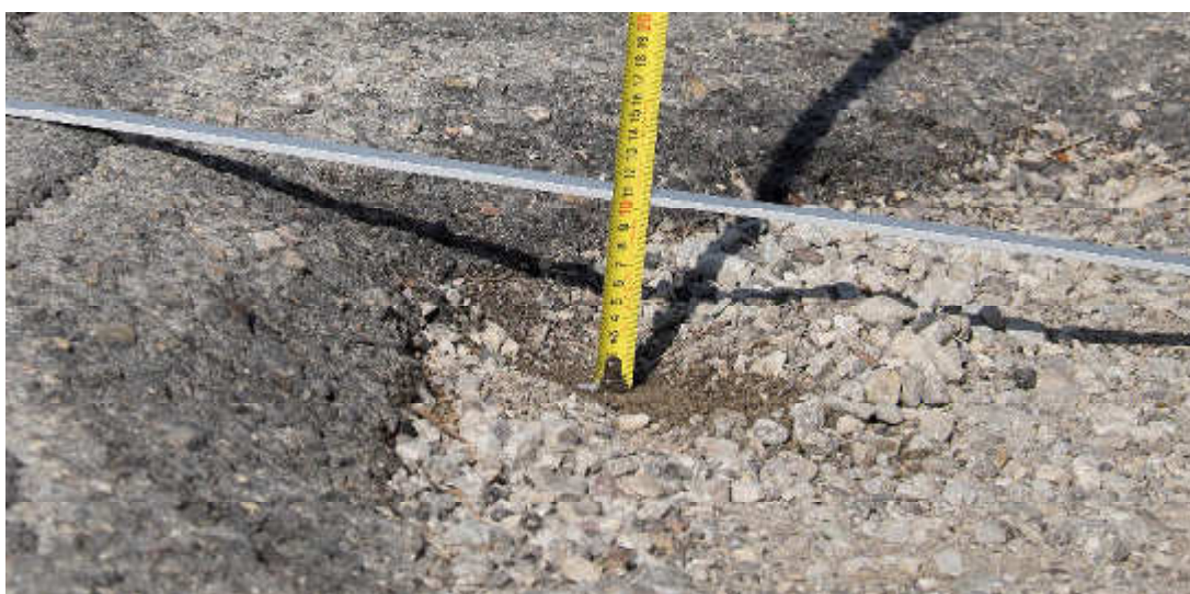
Scheda 1 - Fotografia n° 2 - MISURAZIONE PROFONDITA' DISLIVELLO
